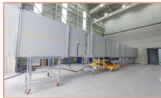
소음기 성능시험설비 Silencer test facility
